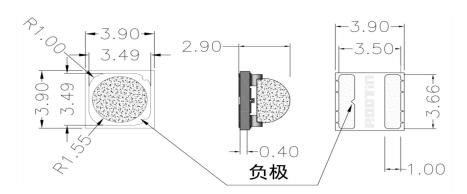
注意:为了获得更好的稳定输出功率,UV LED需要良好的散热环境或者散热系统,建议灯珠在工作状态中,支架温度不要超过50摄氏度。
